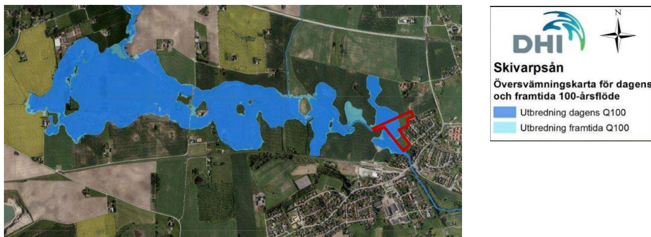
FIGUR 20. ÖVERSVÄMNINGSKARTA FÖR DAGENS OCH FRAMTIDA 100-ÅRSFLÖDEN. PLANOMRÅDET ÄR SCHEMATISKT MARKERAT I RÖTT.
