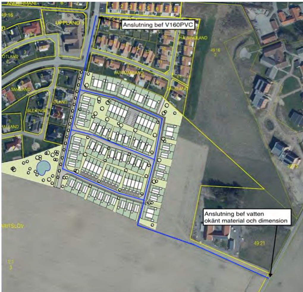
Figur 8: Översikt vattenledningssystem. Bild: VALOGIK AB, 2022-12-16, rev. 2024-01-17.
